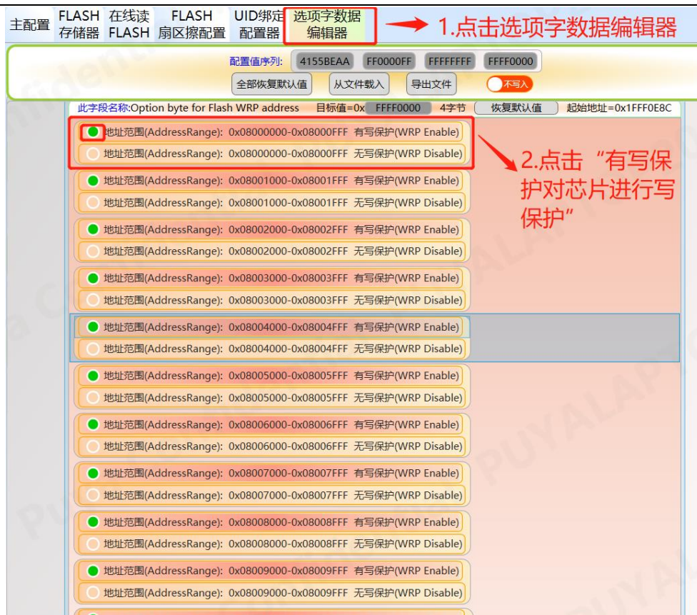
图 12-2 轩微操作 Option 写保护
